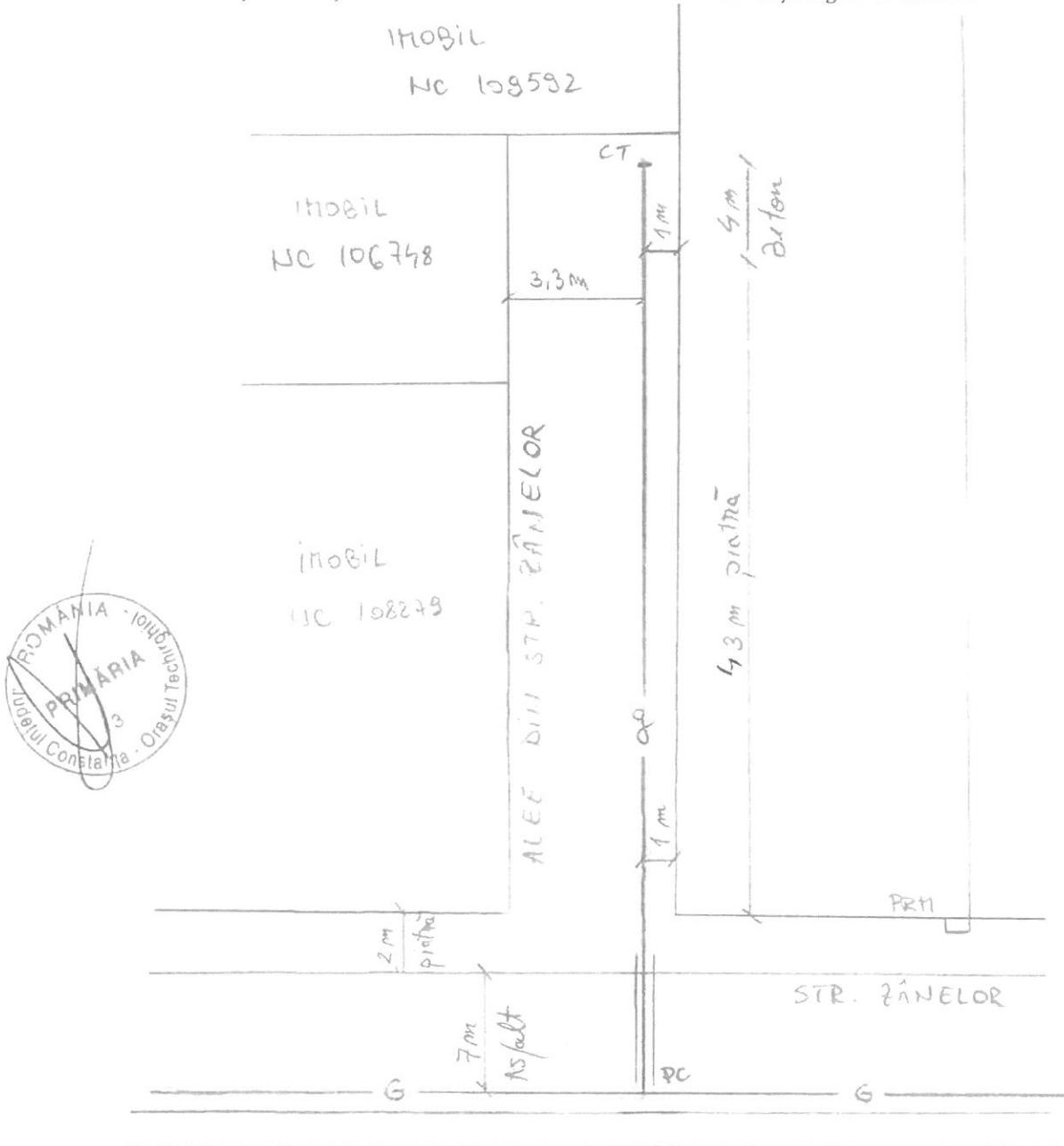
1 - G - Conducătoare existență în 100 SDR Dm 6,3 mm MP
